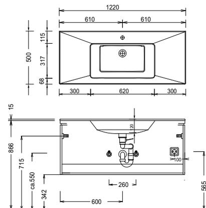
Bei Waschtischanlagen mit Befestigungsschrauben müssen die Maße zum Bohren vor Ort, nach dem Auflegen des Waschtisches auf den Unterschrank, angezeichnet werden. Waschtische ohne Befestigungskonsolen werden mit Silikon an der Wand und auf den Möbelseiten befestigt!
